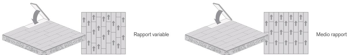
Las flechas deben apuntar todas en la misma dirección con la unión de las lamas Skinny Plank unidas desplazadas en dirección longitudinal. La instalación en ashlar se puede hacer a media junta o a juntas variables, siendo la segunda opción la mejor para productos Microtuft.
