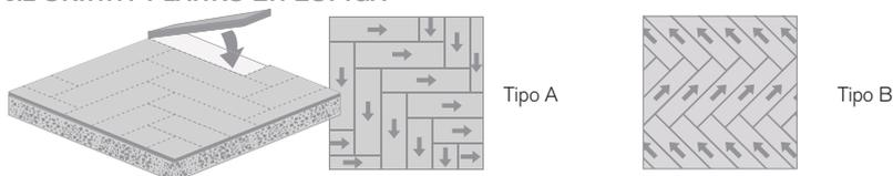
Puede crearse un diseño en espiga de dos formas, lo que requiere niveles de planificación diferentes. El diseño en espiga se crea colocando Skinny Planks en un diseño en L. El punto de inicio puede estar en un ángulo de 90 grados (tipo A) o de 45 grados (tipo B).
