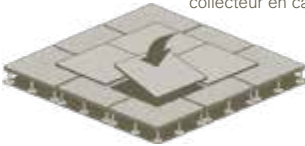
Chevaucher les joints du faux-plancher
