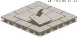
Chevaucher les joints du faux-plancher
