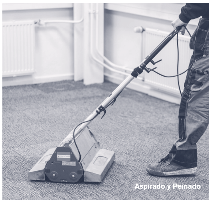
Limpieza por Aspiración
