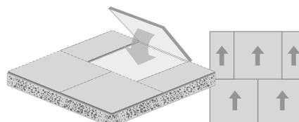
Les flèches pointent toutes dans la même direction avec un décalage d'une demidalle dans la largeur.
