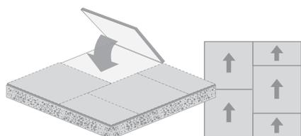
Les flèches pointent toutes dans la même direction avec un décalage d'une demidalle dans la longueur.
