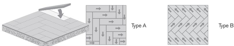
Pour le motif en chevrons, il est possible de positionner les planches étroites de deux façons qui nécessitent un niveau de planification différent. Le chevron est créé en disposant les lames en L, mais le point de départ peut se situer à un angle de 90 degrés (type A) ou à un angle de 45 degrés (type B).
