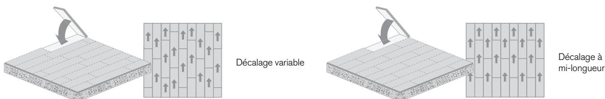
Pour la disposition en recouvrement, les mêmes méthodes de planification et d'installation s'appliquent que pour les dalles de moquettes de taille standard. Les flèches doivent toutes être dirigées dans la même direction avec le joint de la lame Skinny Plank, décalé dans le sens de la longueur. L'installation en recouvrement peut être effectuée soit en recouvrement avec décalage d'une demie-lame, soit en recouvrement variable en fonction de la chute, en particulier pour les produits Microtuft.
